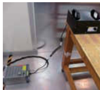
伝導エミッション測定 (電源ポート((9)150 kHz-30 MHz) (電気通信ポート(150 kHz-30 MHz))
