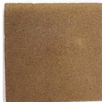
図6 AEM型水電解用ガス拡散電極外観
