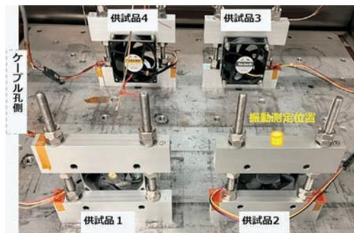
図1 供試品の振動テーブル取付け状態
