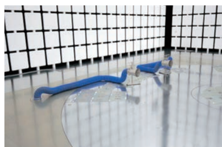
排気ガスダクト
