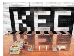
CISPR 25 伝導エミッション測定 (電圧法及び電流法)
