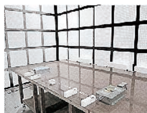
CISPR 25 放射エミッション測定 (ALSE法:~1GHz)
